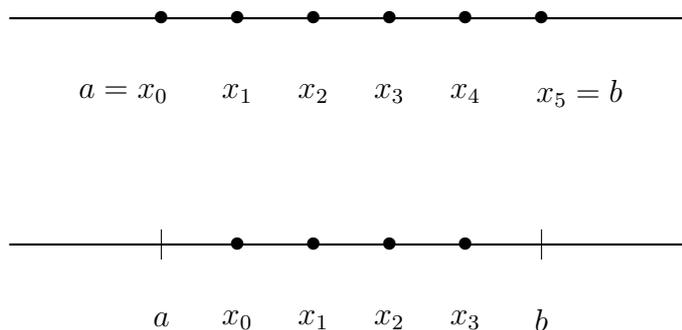
Figure 1: Newton-Cotes cerrada (superior) y abierta (inferior)
